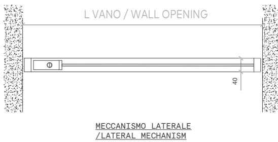
Sezione orizzontale Horizontal section
